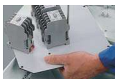
Монтаж устройств на монтажную плату
