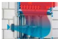
Вентиляция корпуса с помощью вентилируемых фланцев
